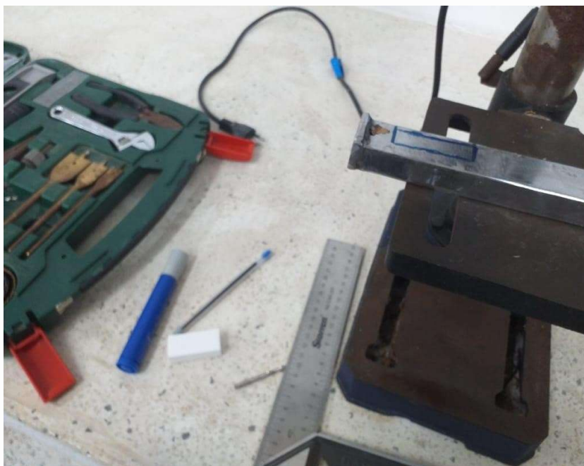
Figura 5: Medições e marcações na barra. Em destaque furo para encaixe da estrutura eletrônica (Fonte: Acervo pessoal, 2023).
