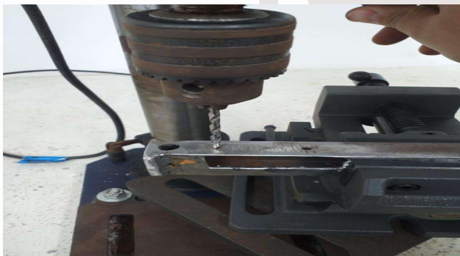
Figura 6: Processo de furação para conexão da estrutura (Fonte: Acervo pessoal).
