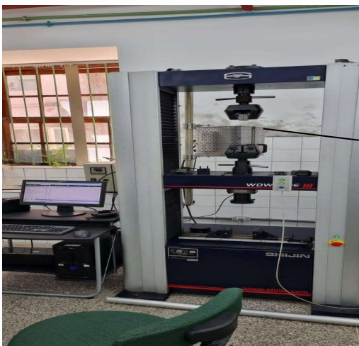
Figura 4: Ensaio de tração em laboratório (Fonte: acervo pessoal, 2023)
