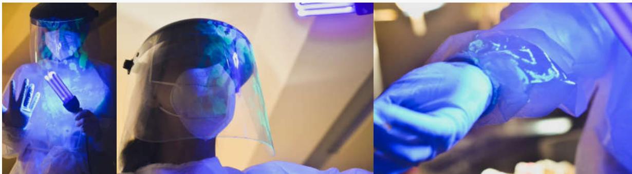
Figura 15: Contaminação limitada à região superior do operador.
