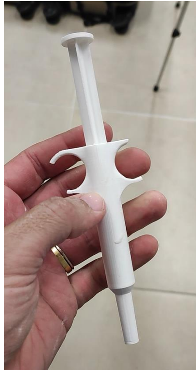
Figura 21. Injetor travado com alças danificadas.
