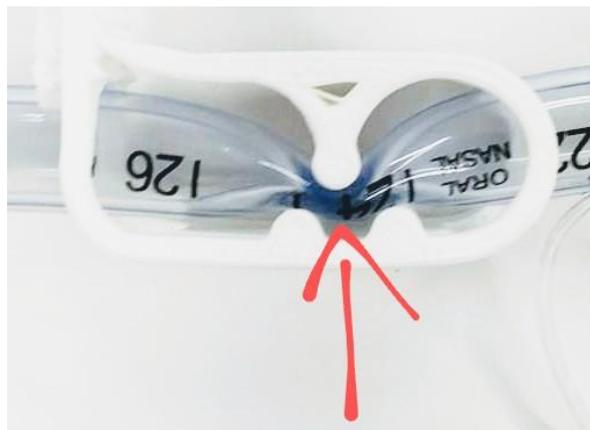
**Figura 5:** Detalhe da deformidade provocada pelo clamp no tubo endotraqueal. Note que a parede anterior do tubo encosta na parede posterior, permitindo uma vedação inclusive para gases.
